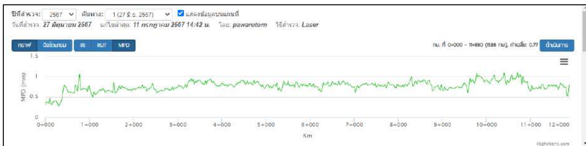
รูปที่ 7 ทางหลวงหมายเลข 332 ตอนควบคุม 100 เขาหาดยาว – หุ่งโปรง กม.ที่ 0+000 – กม.ที่ 11+880 ค่า MPD เลน L
