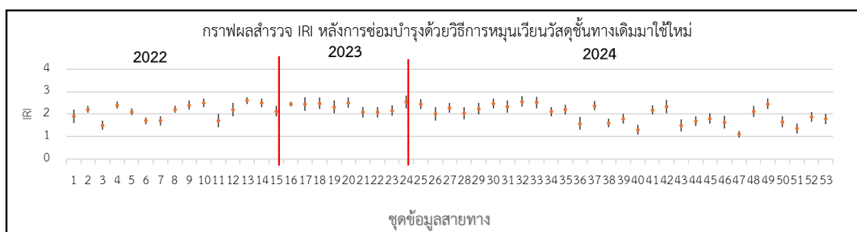
รูปที่ 2-94 ผลสำรวจ IRI ภายหลังการซ่อมบำรุงด้วยวิธีการบูรณะผิวทาง
