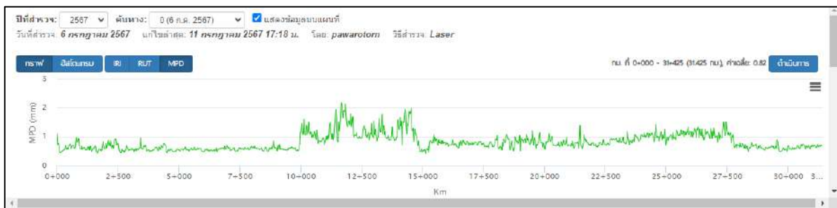
รูปที่ 31 ทางหลวงหมายเลข 109 ตอนควบคุม 100 แม่สรวย – ห้วยป่าไร่ กม.ที่ 0+000 – กม.ที่ 31+425 ค่า MPD เลน L
