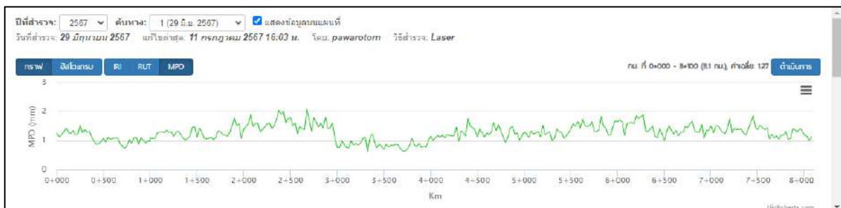
รูปที่ 15 ทางหลวงหมายเลข 2 ตอนควบคุม 101 สระบุรี – ตาลเดี่ยว กม.ที่ 0+000 – กม.ที่ 8+100 ค่า MPD เลน L
