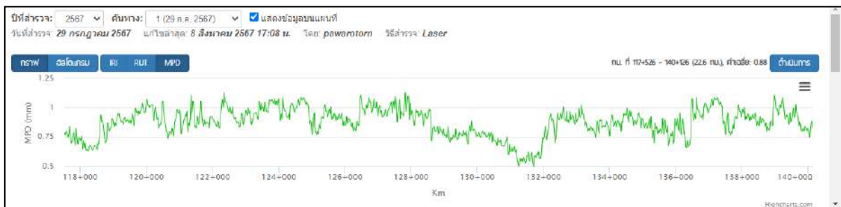
รูปที่ 65 ทางหลวงหมายเลข 41 ตอนควบคุม 202 เกาะมุก – ควนรา กม.ที่ 117+526 – กม.ที่ 140+126 ค่า MPD เลน L
